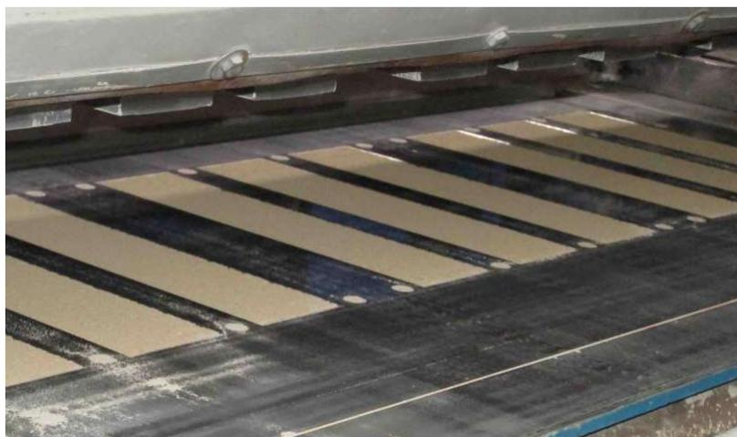
例：焼成前の型づくり、金型による圧力の均一化を図る
